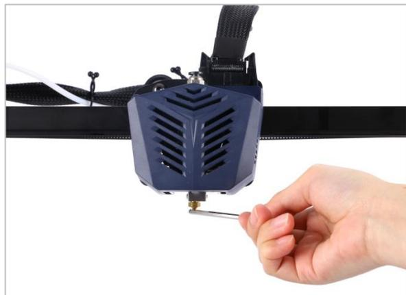
3. Nach erfolgreicher Kalibrierung wird das Gerät automatisch auf Null zurückgesetzt und der Druckkopf und das Heißbett vorgeheizt (wenn es vor dem Nivellieren manuell auf die Zieltemperatur vorgeheizt wurde, überspringt das System automatisch das Vorheizverfahren) und nach dem Vorheizen auf die Zieltemperatur erkennt der Druckkopf automatisch die Plattform zum Nivellieren. Dieser Vorgang dauert einige Minuten, bitte haben Sie etwas Geduld.
