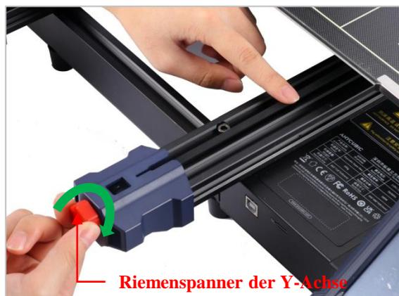
Riemenspanner der Y-Achse
