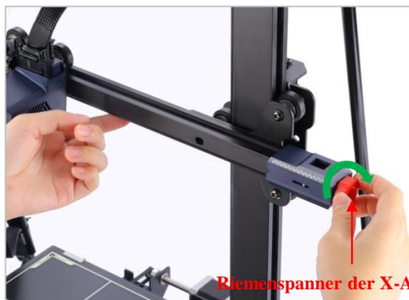
Riemenspanner der X-Achse
