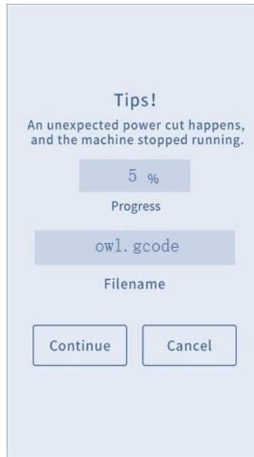
Tipp: Bevor Sie mit dem Drucken fortfahren, entfernen Sie bitte überschüssiges Material an Düse und Modell, um den Druckeffekt nicht zu beeinträchtigen.
