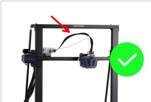
Achten Sie darauf, dass der Kabelbaum des Druckkopfs glatt unter dem oberen Profil geführt wird.
